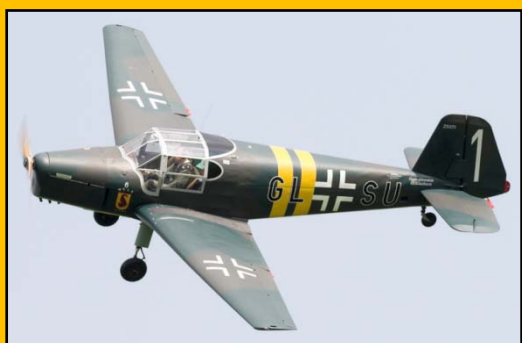
2 Sitzplätze, Motor: hängender, luftgekühlter 4-Zylinder Hirth HM504 (105 PS), Spannweite 10,40 m, Länge: 7,35 m, Leermasse = 400 kg, max. Startmasse = 705 kg, Reisegeschwindigkeit: 172 km/h, Reichweite = 800 km
